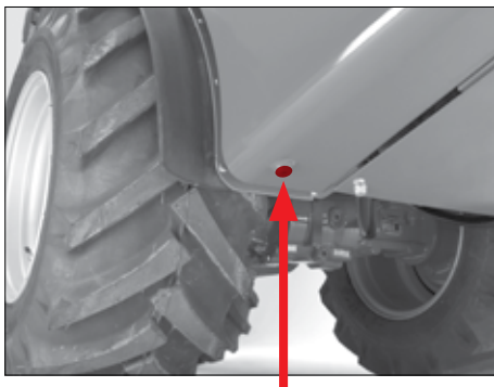
Fig. 116 Prop til tømning af hydraulisk olie
