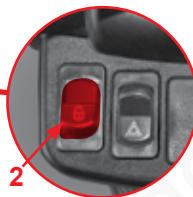
Fig. 46 Åbning af hydraulisk lås til ophængte redskaber
