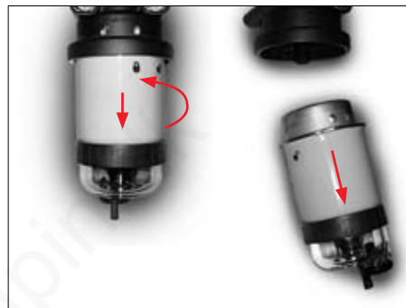
Fig. 103 Udskiftning af brændstoffilter
